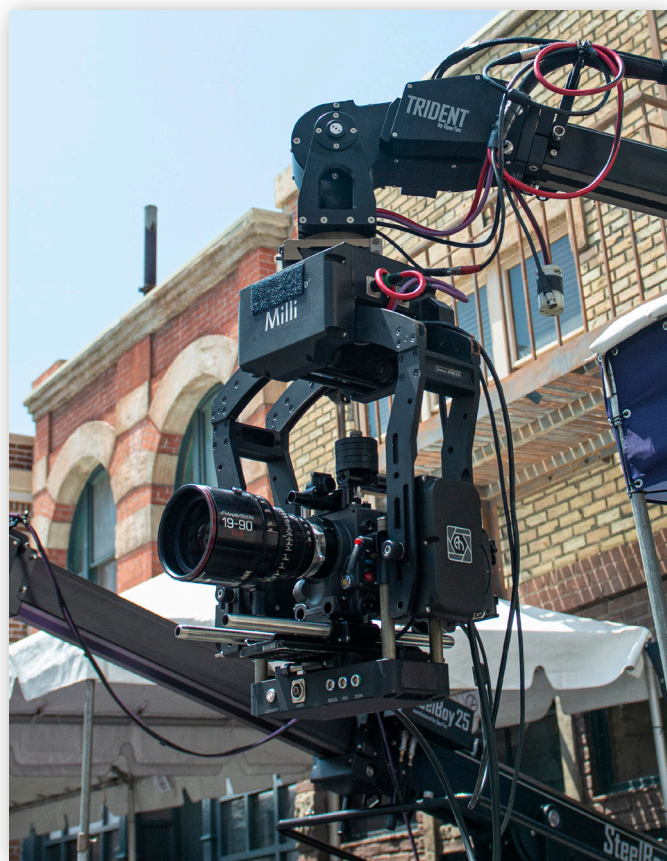
Активная гиростабилизированная головка OperTec Milli
