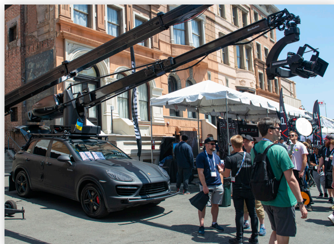
Установленный на джипе операторский кран Filmotechnic
