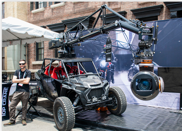
Кран с гиростабилизированной моторизованной головкой, установленный на багги
